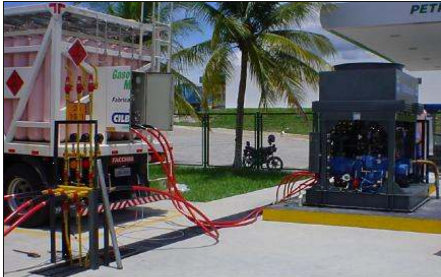
Imagen 5: Proceso de llenado de cilindros en Brasil
