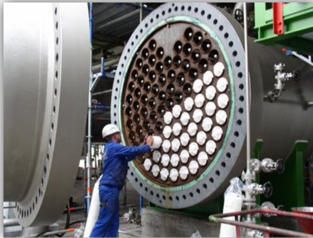
Figura 8. Filtros de cartucho para grandes caudales de agua de proceso
