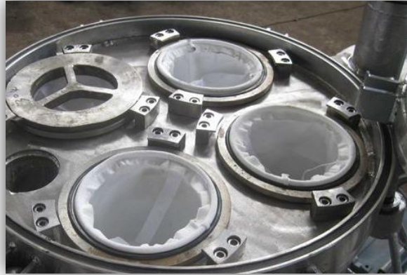
Figura 9. Carcasa y filtros de bolsa para pintura
